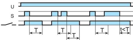
**(BE) Off-delay with control signal.**
