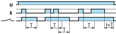
**(BE) Off-delay with control signal.**
