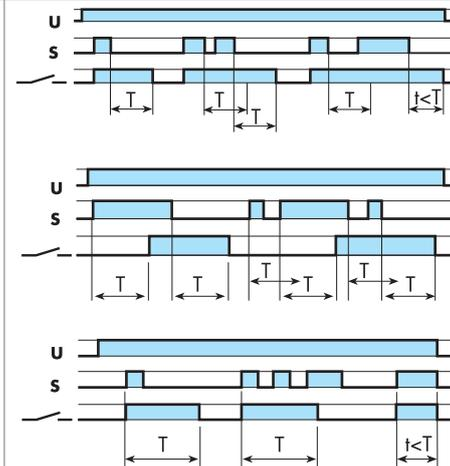
**(BE) Off-delay with control signal.**
