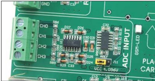
Figure 7-1: ADC module
