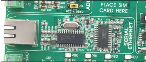
Figure 8-1: Ethernet module
