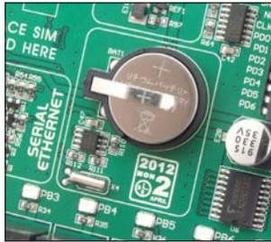
Figure 10-1: RTC module
